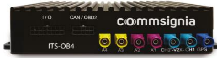
Şekil 46 Commsignia firmasının ITS-OB4 isimli OBU cihazı
