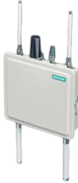
Şekil 37 MoboTrex firmasının Yunex isimli RSU cihazı
