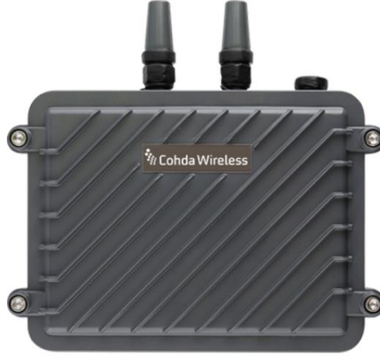
Şekil 40 Cohda Wireless firmasının MK5-XBU isimli RSU cihazı
