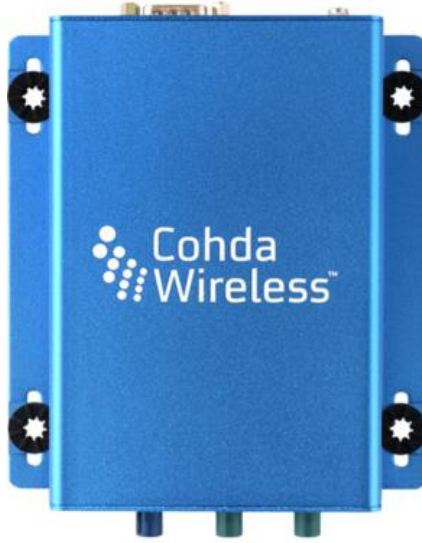
Şekil 39 Cohda Wireless firmasının MK5 isimli OBU cihazı
