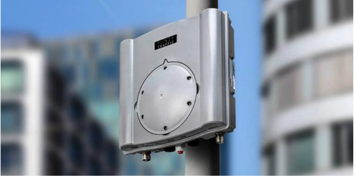
Şekil 15. Direğe Monte Edilmiş Bir Yol Kenarı Birimi (RSU)
